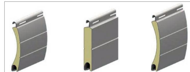
La espuma de poliuretano tiene un coeficiente de conductividad térmica (W/mK) en torno a 0,025. Cuanto mayor sea su densidad, se consigue una mayor dureza y un menor coeficiente de transmisión de calor (W/m<sup>2</sup>K).
