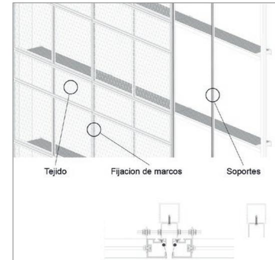
**Sistemas envolventes:** Sistema textil pretensado en obra, permitiendo resolver geometrías complejas y así obtener libertad de formas. Permite realizar envolventes más grandes sin juntas, todo en una única pieza, limitándose a criterios de manejo, o sustitución.
