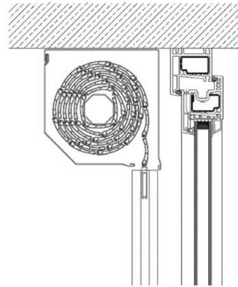
Figura 93. Sistema integrado en obra
