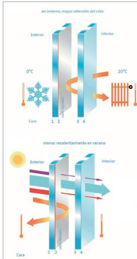
El recubrimiento bajo emisivo reduce la energía de radiación que se transmite desde la hoja interior a la exterior en un factor de 1 a 20. Dado que la energía por radiación es la forma principal de transmisión de calor en una unidad de vidrio aislante, su transmitancia se puede reducir de 2,7 a 1,3 W/m<sup>2</sup>K. Si, además, se introduce argón en vez de aire en la cámara entre las hojas de vidrio, la transmitancia se puede reducir a 1,0 W/m<sup>2</sup>K.
